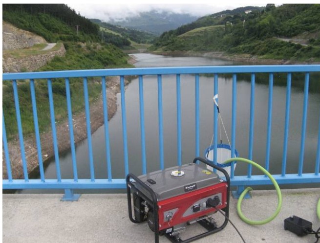
Figura 10. Tomando una muestra con la técnica de bombeo en el embalse de Ibiur.
